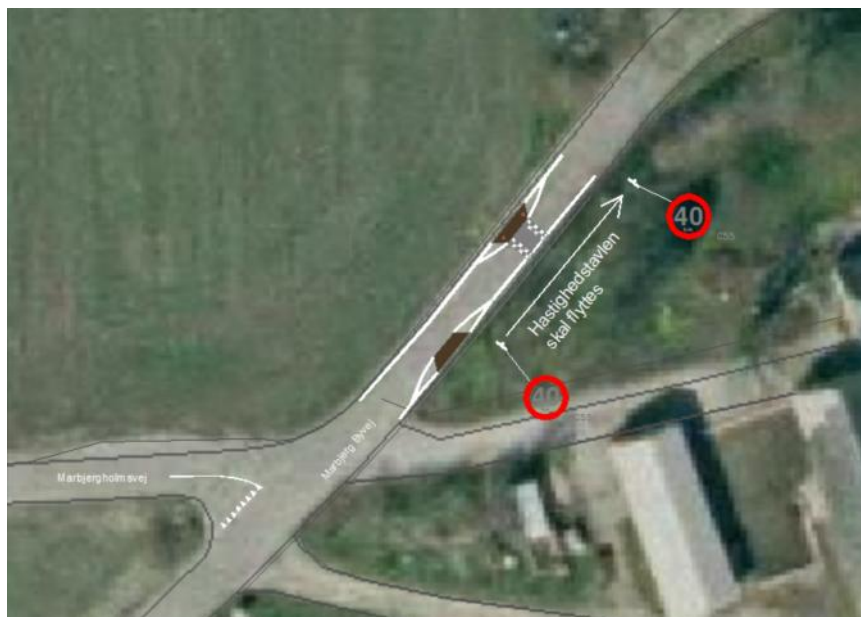
Figur 20. etablering af bump anlæg ved indsnævring
